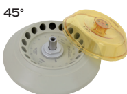
Rotor angular, 18-posiciones, No. 01258-A n = 14,000 min -1 , RCF máx 16,654
