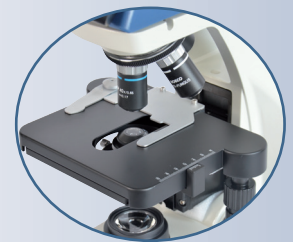
PLATINA MECANICA CON CREMALLERA INTERNA
